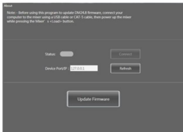
2.2 Click 2.2 Haga clic en el botón de "Refresh" para escanear el dispositivo. Y luego aparecerá la dirección IP o COM del dispositivo, dependiendo el método de conexión que se está utilizando. Haga clic en el botón "Connect". Si la luz de estado es verde, el dispositivo está conectado correctamente.
